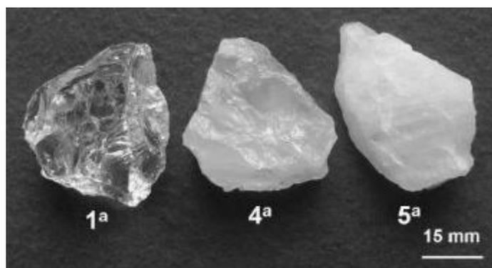
Figura 13 – Lascas de quartzo natural classificada por inspeção visual
