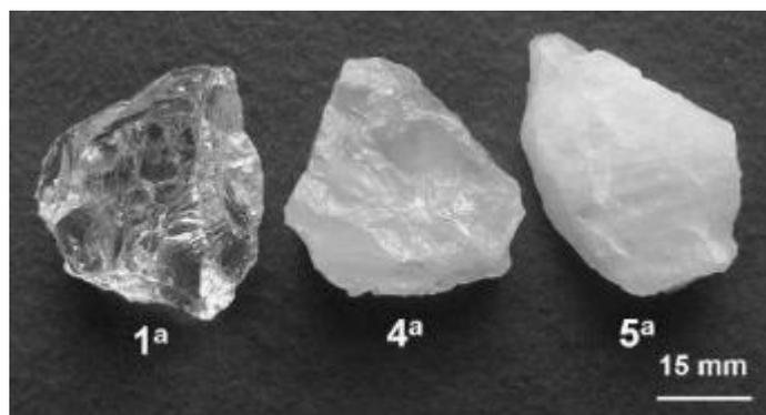
Figura 1 – Lascas de quartzo natural classificada por inspeção visual
