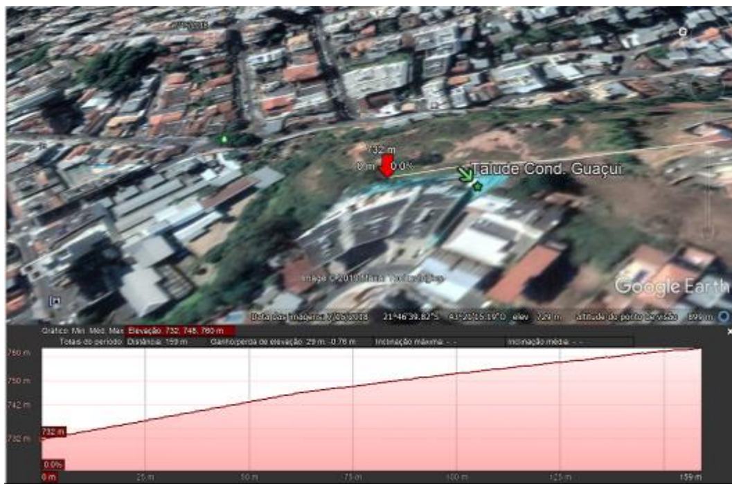
Figura 10.4: Perfil do divisor de águas a montante do talude com cota variando de 732 a 760 m.
